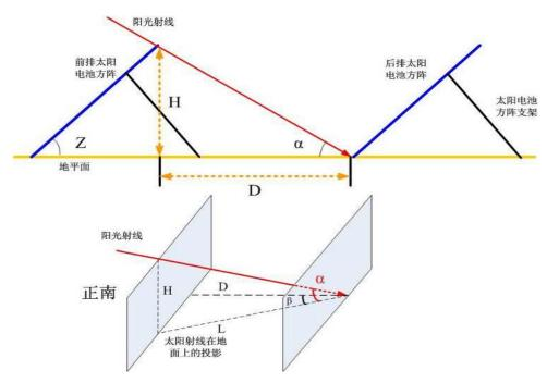
通过计算得到: 固定光伏方阵的前后排中心间距为 1600mm 时可以保证南、北两排方阵在上午 9 点到下午 3 点之间,前排不对后排造成遮挡。
